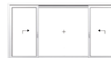
Schema K 2 křídla, 1 pevné zasklení
